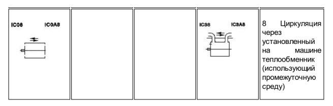
Таблица А.2 - Примеры для замкнутых первичных цепей охлаждения и разомкнутых вторичных с использованием окружающей среды для охлаждения
